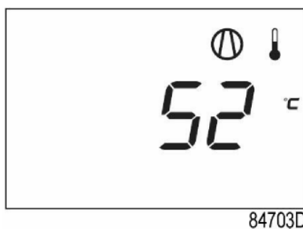
Pagină principală cu afișarea temperaturii (compresor oprit)
