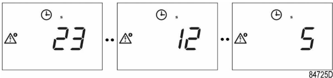
Exemplu de numărătoare inversă a timpului de amânare a repornirii automate după o pană de curent.
