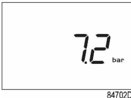
Pagină principală cu afișarea presiunii (compresor oprit)
